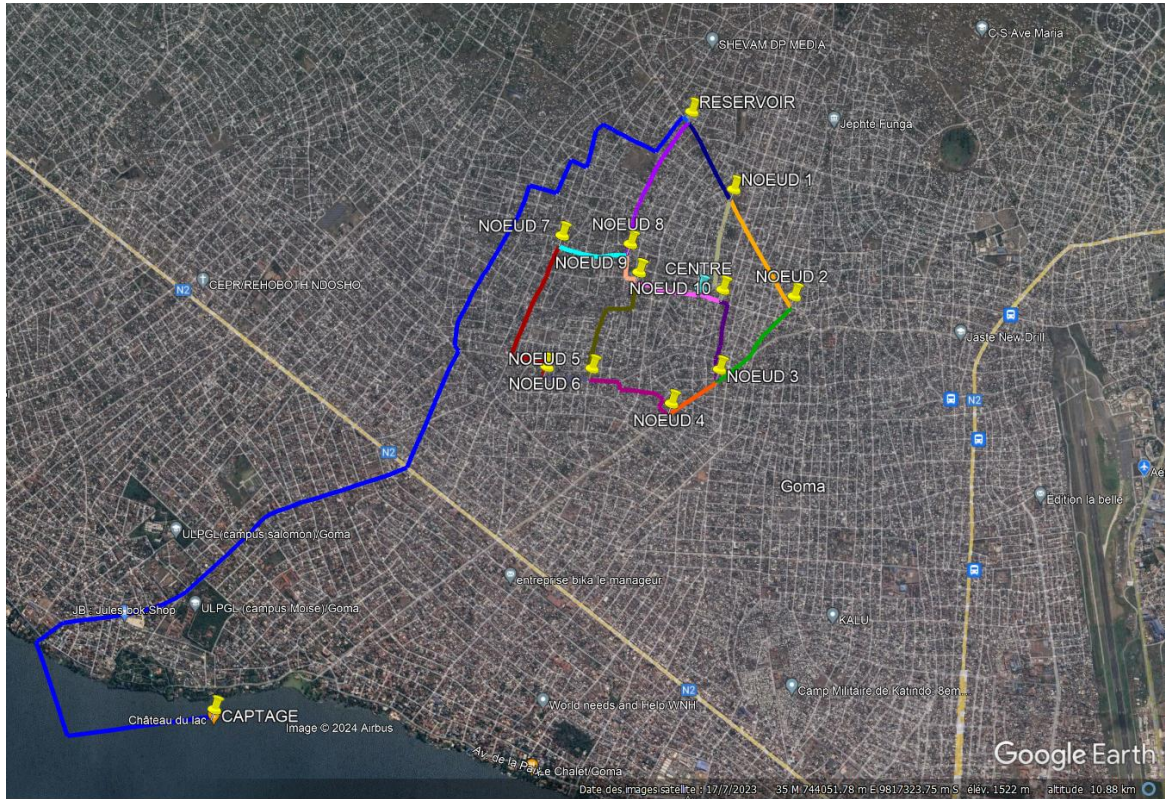
Figure III-1 : réseau établi pour le village NGANGI 3
