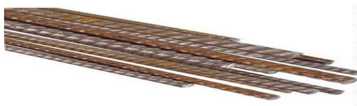
Figure I-3 Représentation d'une barre à Haute adhérence HA [10]
