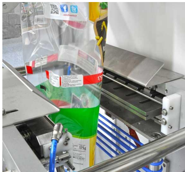
Figure 5 : Un système de scellage par chaleur [34]
