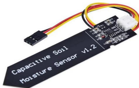
Figure 12: Image d'un capteur d'humidité de sol capacitif [23]
