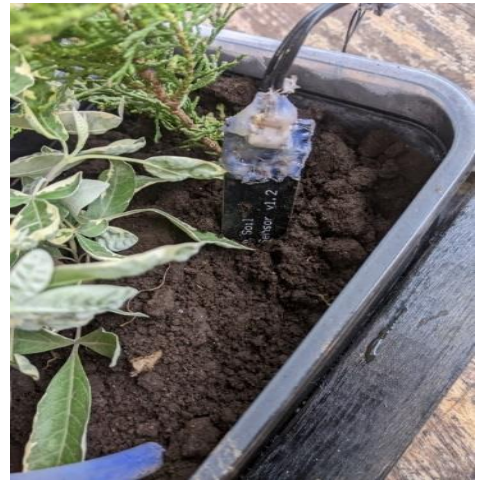
Figure 32: capteur d'humidité du sol enfui dans la terre pour en récolter le taux d'humidité
