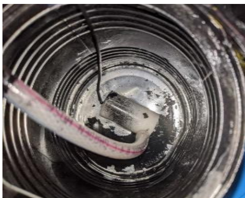
Figure 35: pompe immergée dans le réservoir pour aspirer de l'eau
