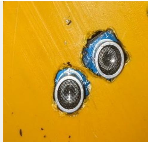
Figure 34: Capteur de niveau d'eau placé sur le couvercle du réservoir
