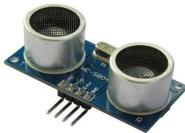
Figure 13: Capteur de distance ultrason HC-SR04 [24]
