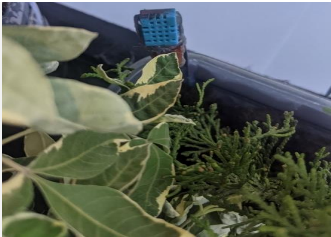
Figure 33: capteur d'humidité et de température de l'air ambiant dans le champ
