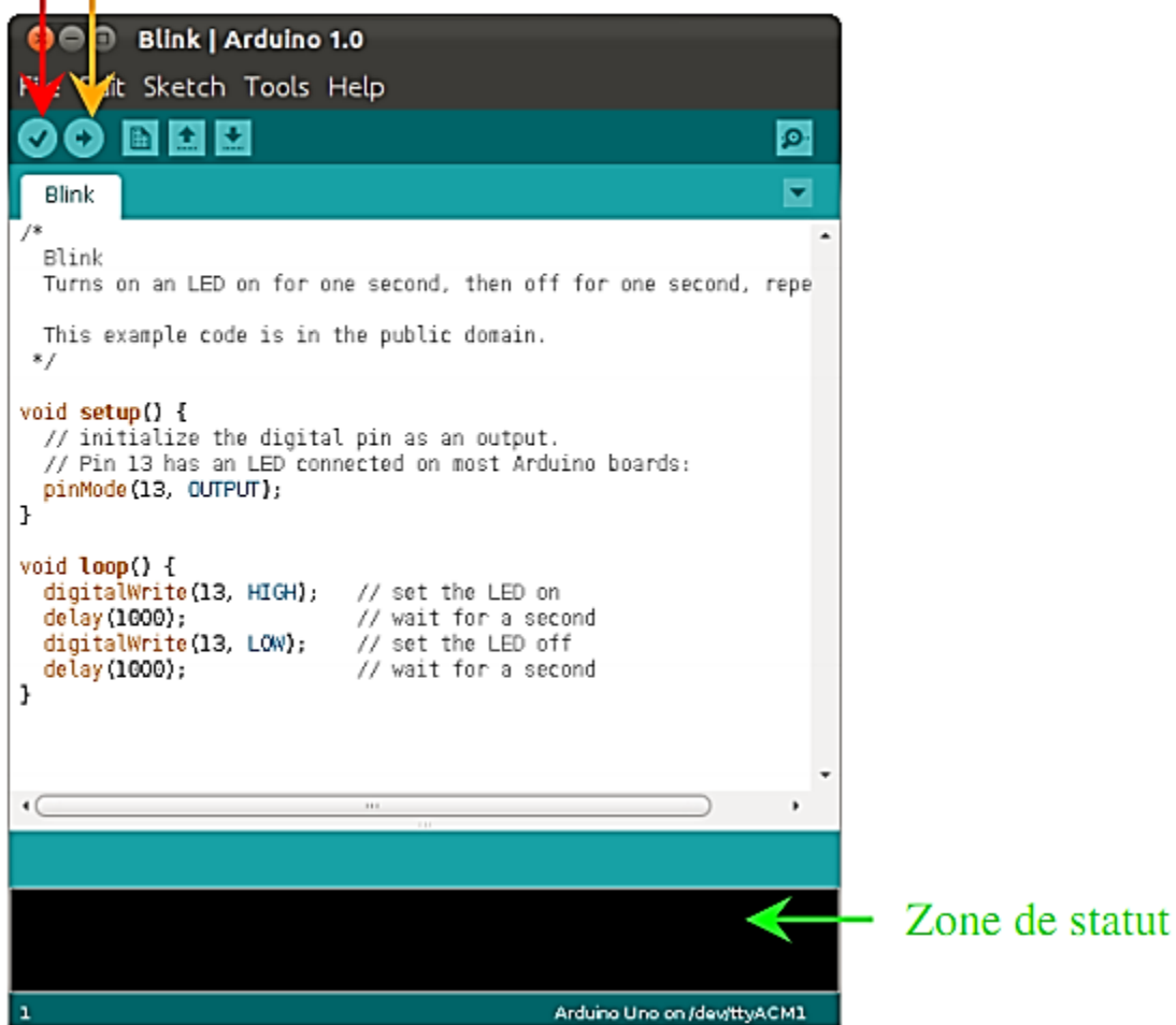
Figure III. 17 : Structure d'un programme en Arduino
