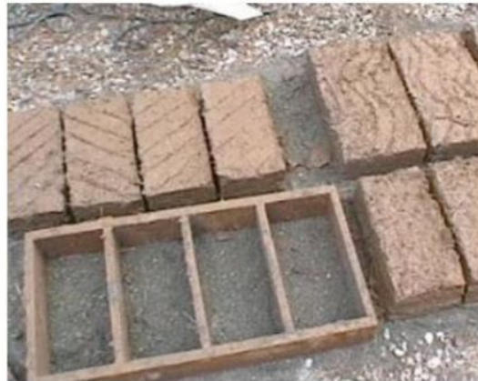
Figure I:2. Technique de fabrication de l'adobe
