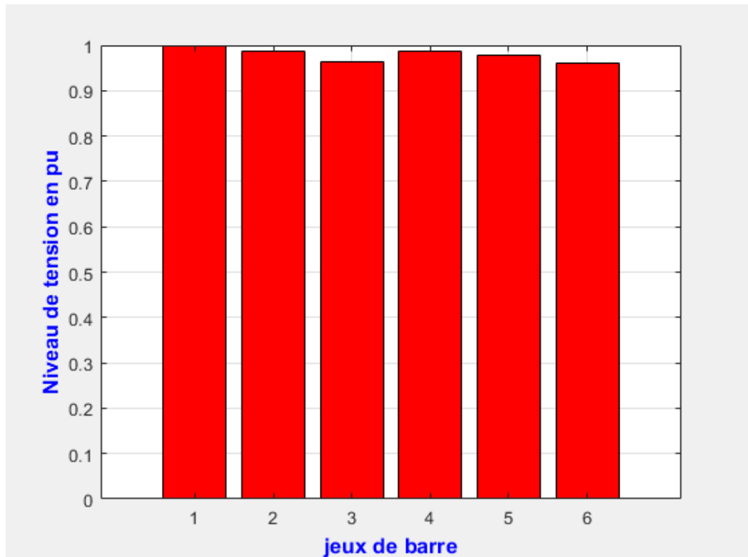
Figure 3.5 : Profil de tension après insetion d'un SVC
