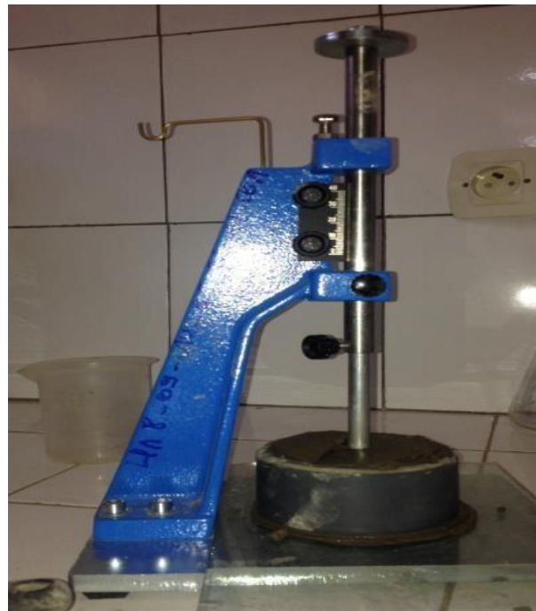
Figure 3 Appareil de Vicat muni d'une sonde.
