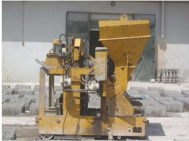
Figure I-3 : Machine mobile « Pondeuse » plate-forme Chetouane.
