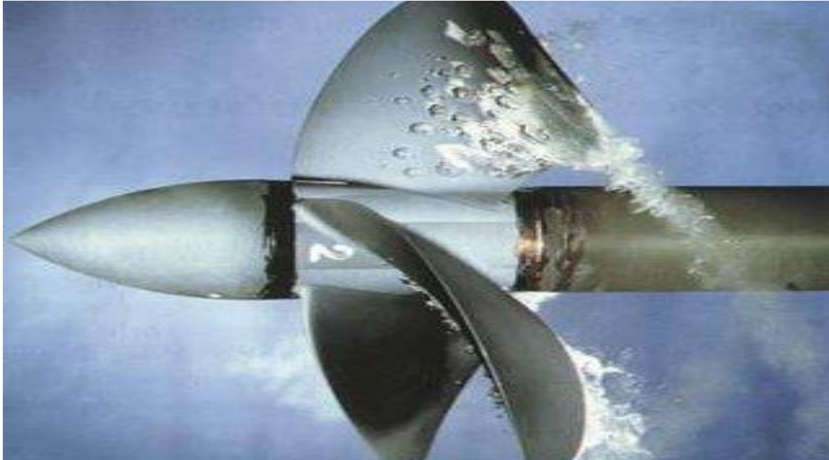
Figure 1.3 : apparition de bulles de cavitation sur les pales d'une hélice.
