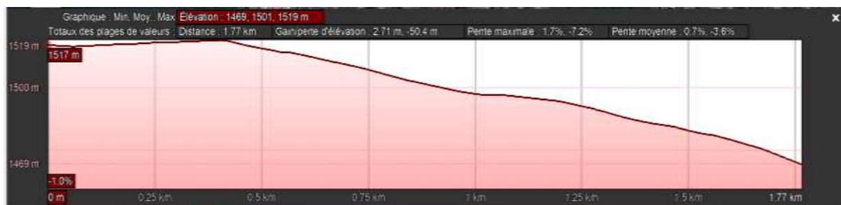
Figure II.1. Creux et différence de niveau entre la fin et le début du caniveau.
