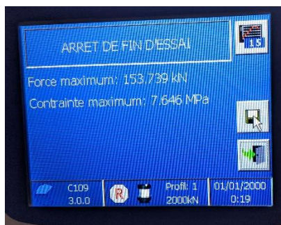
ANNEXE 4 : Les résultats de la résistance en compression du béton ordinaire.
