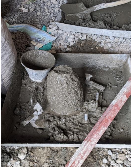
ANNEXE 3 : Essai au cône à gauche et compression du béton ordinaire à droite.
