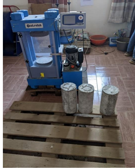
ANNEXE 3 : Essai au cône à gauche et compression du béton ordinaire à droite.
