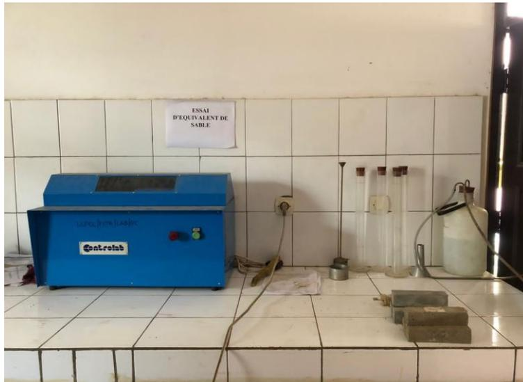
*Figure 2.2 Matériels utilisés pour l'équivalent de sable*
