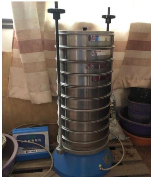
*Figure 2.1 Colonne de tamis pour l'analyse granulométrique et la tamiseuse électrique*
