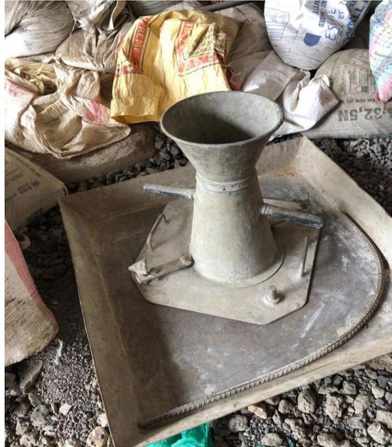
*Figure 2.5 Cône d'Abrams*
