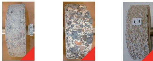
Figure 19. Exemple de bétons soumis à une attaque acide où le premier béton est tenue correct, le second béton est mauvaise tenue-Granulats siliceux et le troisième béton est mauvaise tenue-Granulats calcaires [31].
