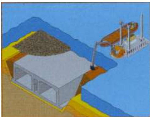
Figure 1-14 : Remblayage de la tranchée
