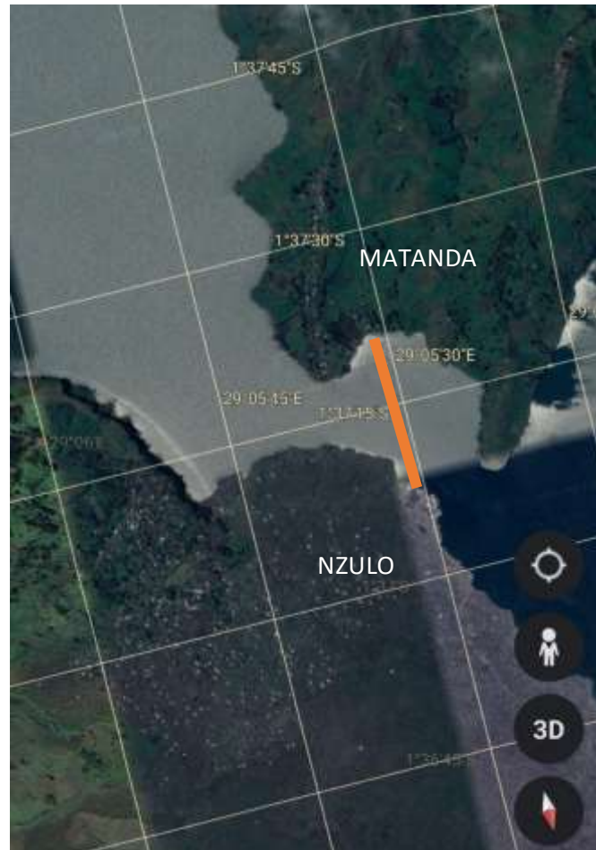
Figure 3-6 : Implantation du tunnel immergé à Nzulo
