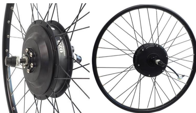
Figure 41: Moteur intégré dans la roue [42].
