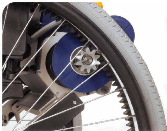
Figure 38: Transmission par engrenage avec couronne intérieure dans la roue [40].
