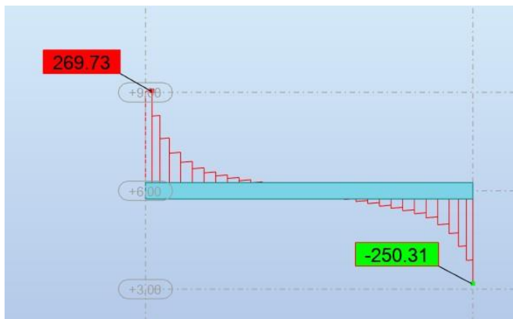
Figure 3-4 : moment fléchissant de la poutre en BP à l'ELS
