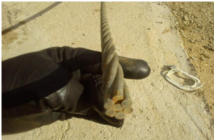
Figure 1-13 : Un toron à 7 fils (T15) [1]
