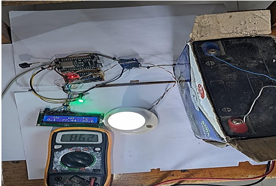
Figure 27: Photo comparative : écran multimètre + écran LCD du BMS
