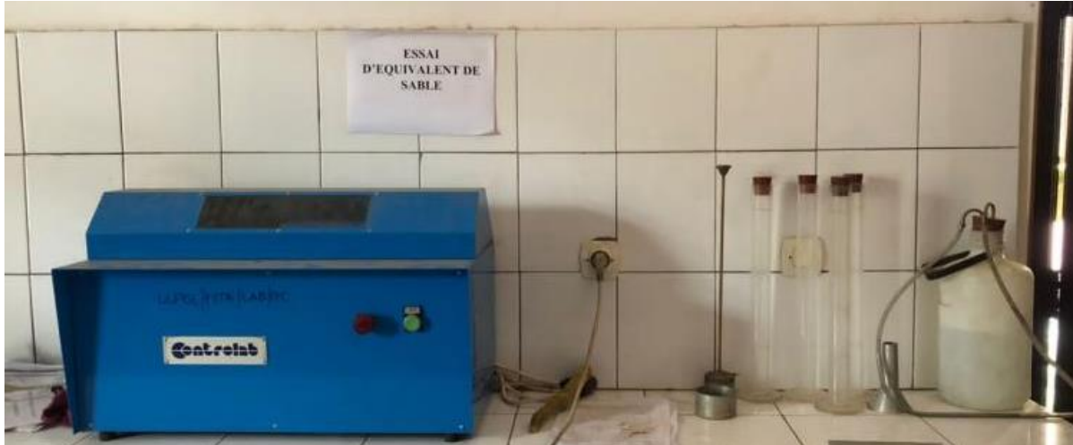
Figure 2.2 : Agitateur ,piston ; éprouvettes
