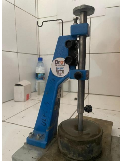
Figure 2.4 : Appareil de Vicat avec Sonde
