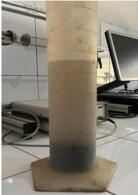
Figure 2-3 Eprouvette graduée pour la masse volumique absolue.
