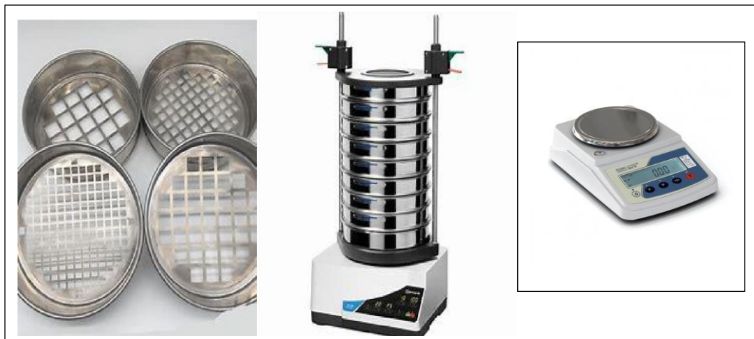
Figure 2.3 Appareillage de l'essai d'analyse granulométrique
