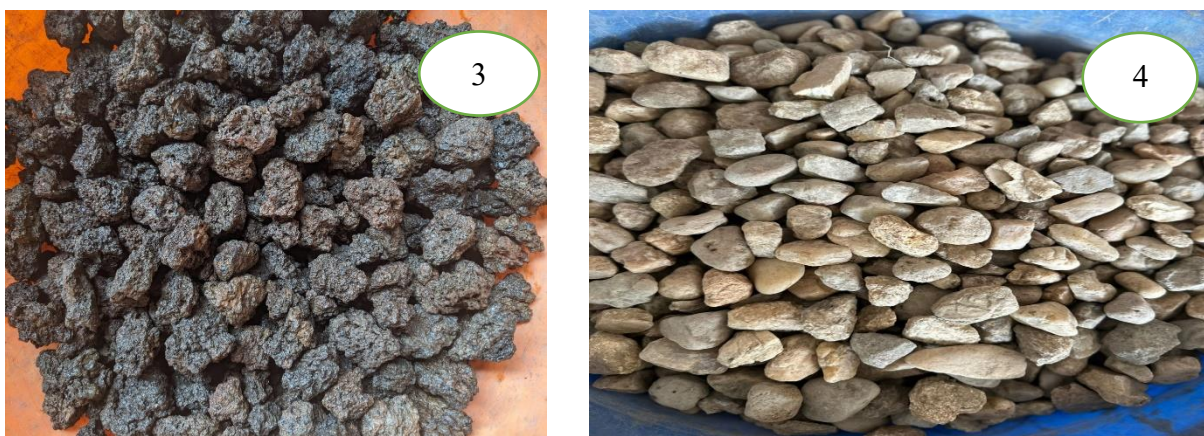
Figure 2.2 Granulats utilisés : (1) Sable de Rwanda, (2) Grapiers concassés, (3) Grapiers tout-venants, (4) Grapiers roulés
