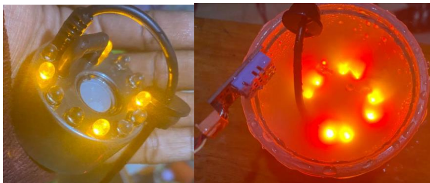
Figure 3-12 Brumisateur et test de l'humidité
