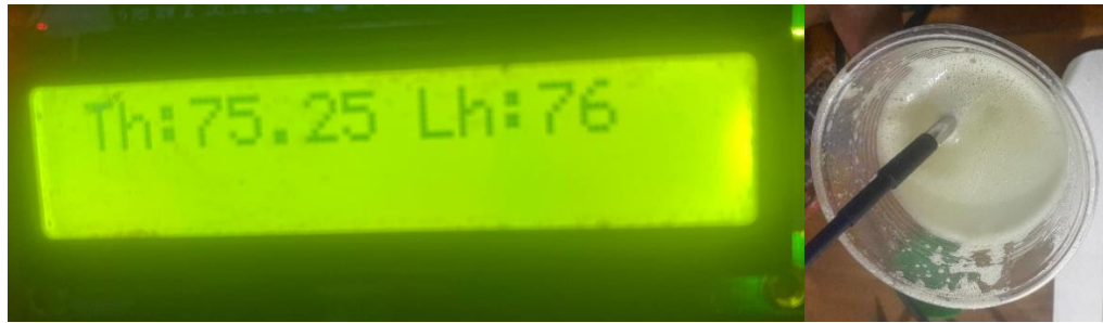
Figure 3-17 Affichage de résultat sur LCD et sonde plongée dans l'eau chaude
