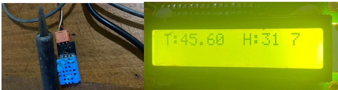
Figure 3-10 Test avec fer à souder
