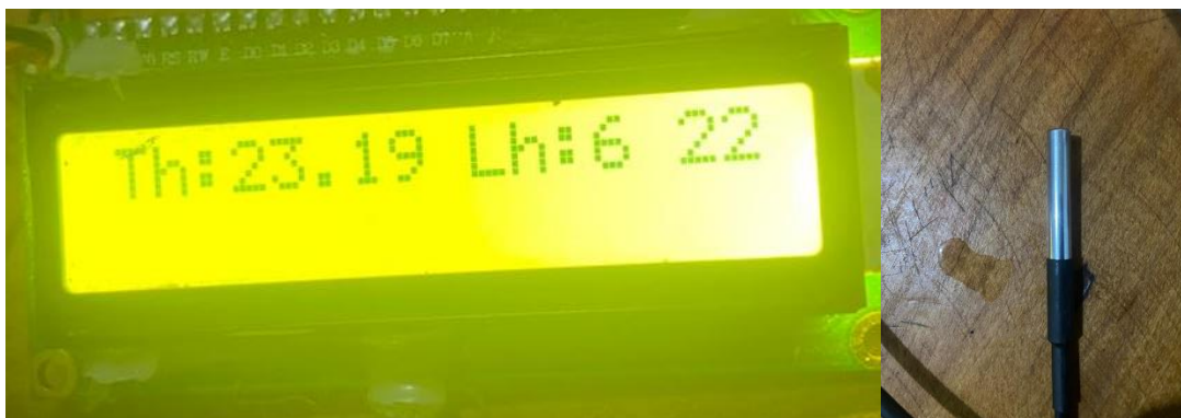
Figure 3-15 Affichage de résultat sur LCD et sonde a l'air libre
