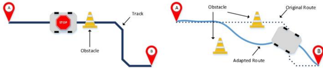
Figure 2 Schéma comparatif entre un AGV et un AMR [24].
