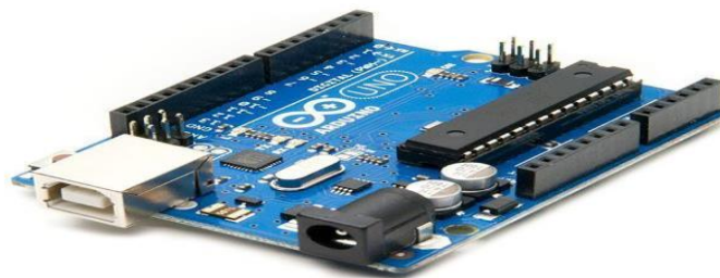
Figure IV-1 : la carte Arduino Uno
