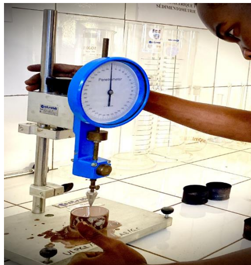
Figure 2-8 Illustration de l'essai au pénétromètre à cône
