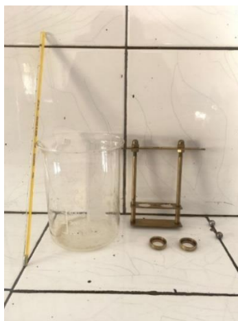
Figure 2.5 : Le thermomètre, le récipient pour baigne-vase cylindrique en verre, les anneaux, le support d'anneaux, et les billes
