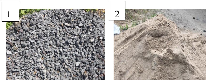
Figure III-2 Granulats utilisés: (1) Gravier concassés et (2) Sable du Rwanda
