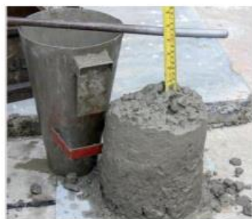
Figure 2-5 : Détermination de l'affaissement au cône d'Abrams
