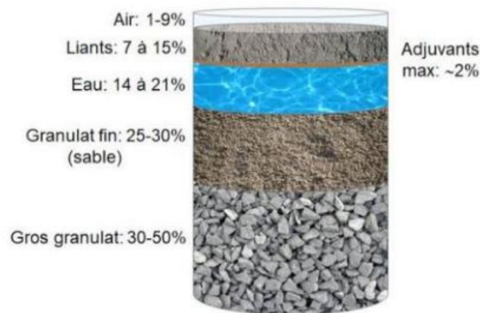
Figure 1-1 : Constitutions du béton [7]
