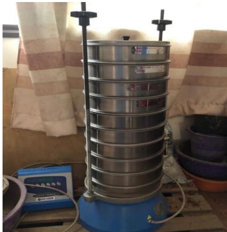
Figure 2-1 Une colonne de tamis pour l'analyse granulométrique et une tamiseuse électrique
