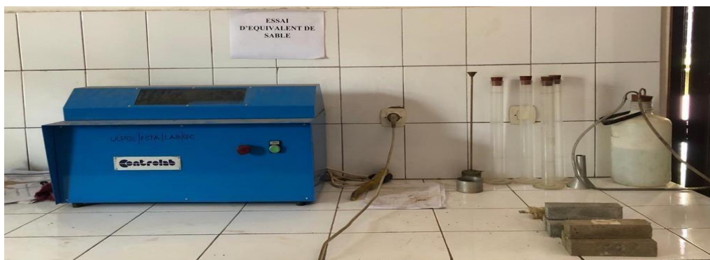
Figure 2-2 Equipement nécessaire pour l'essai d'équivalent de sable
