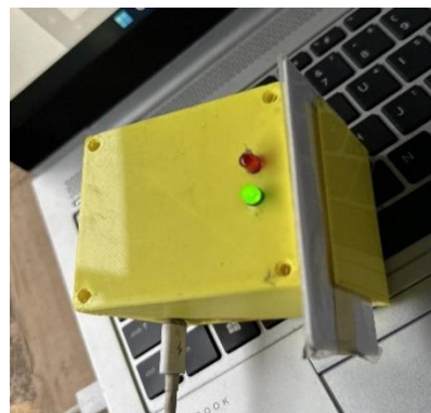
Figure 33 : Présentation du Scanneur avec la carte RFID
