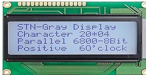
Figure III:26 Écran LCD 4*20 avec différentes broches[27]
